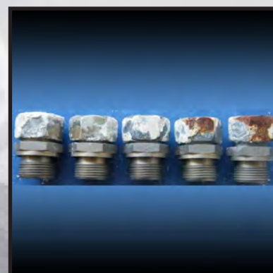
Salzsprühnebeltest nach 780 h
