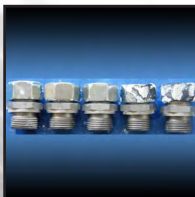
Salzsprühnebeltest nach 190 h
